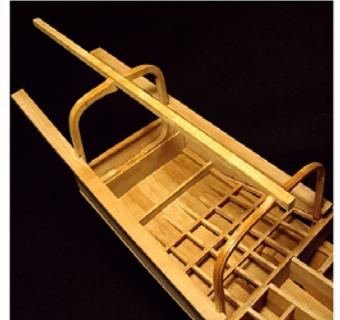
Photo 50 : Vue plongeante dans le carrosse permettant d'observer les courbures de la petite touaille. Les faces avant du siège et des amures sont en place, il reste à poser les parties horizontales de ces éléments.
